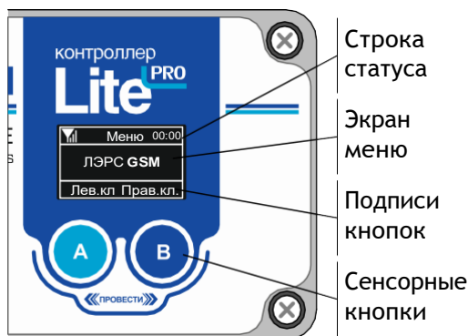
Рисунок 5. Дисплей контроллера LitePro
